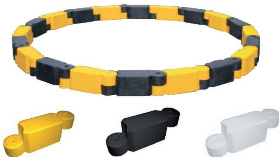
Figura 483 CORDOLO JOLLY Cordolo realizzato in plastica riciclata, ideale per la realizzazione di rotatorie di qualsiasi diametro, cordolature per marciapiedi, aiuole e isole spartitraffico. Atti a sostituire i cordoli in cemento, attenuano l'urto in caso di incidente per una maggior sicurezza. Dimensioni: 52x14,5x17 cm Disponibile: - giallo - bianco - nero
